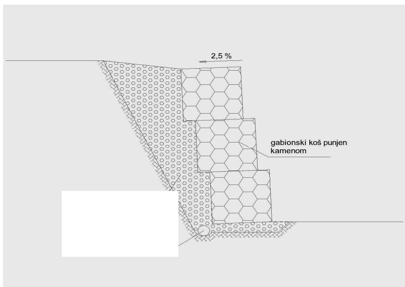
Габиони су сачињени од **двоструко плетене хексагоналне поцинковане, челичне, жичане мреже** која је нерасплетива након резања жице. Димензије окца су 80 x 100мм. Поцинкована жица је пречника 2,7-3,0мм, док је затезна чврстоћа жице 400Н/мм<sup>2</sup>. Габиони се производе у складу са интернационалним АСТМ техничким стандардима за хексагонално жичано плетиво и габионе.
